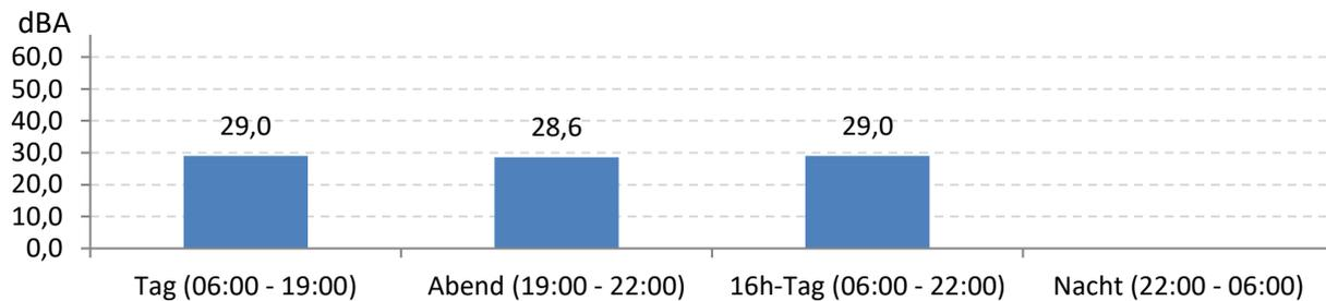
Abb. 8: LEQ bei Pistenbetriebsrichtung "Windstille" 167 Stunden im Messzeitraum
