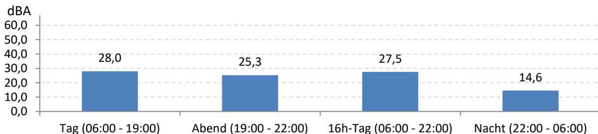
Abb. 9: LEQ bei Pistenbetriebsrichtung "östliche Winde" 239 Stunden im Messzeitraum
